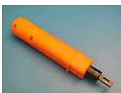
рис 4 ( НТ-314-С) У всех систем кроссировки жила монтируется в разрез контакта, но из-за различий в конфигурациях контакта и корпуса планки для каждого их вида требуется специальный инструмент (punch down tool), с помощью которого провод вдавливается в разрез контакта планки и, если это нужно, обрезается. .(рис4)
